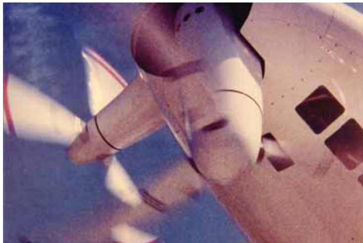
Motores orientables en un dirigible Zeppelin NT Zeppelin Luftschifftechnik.
